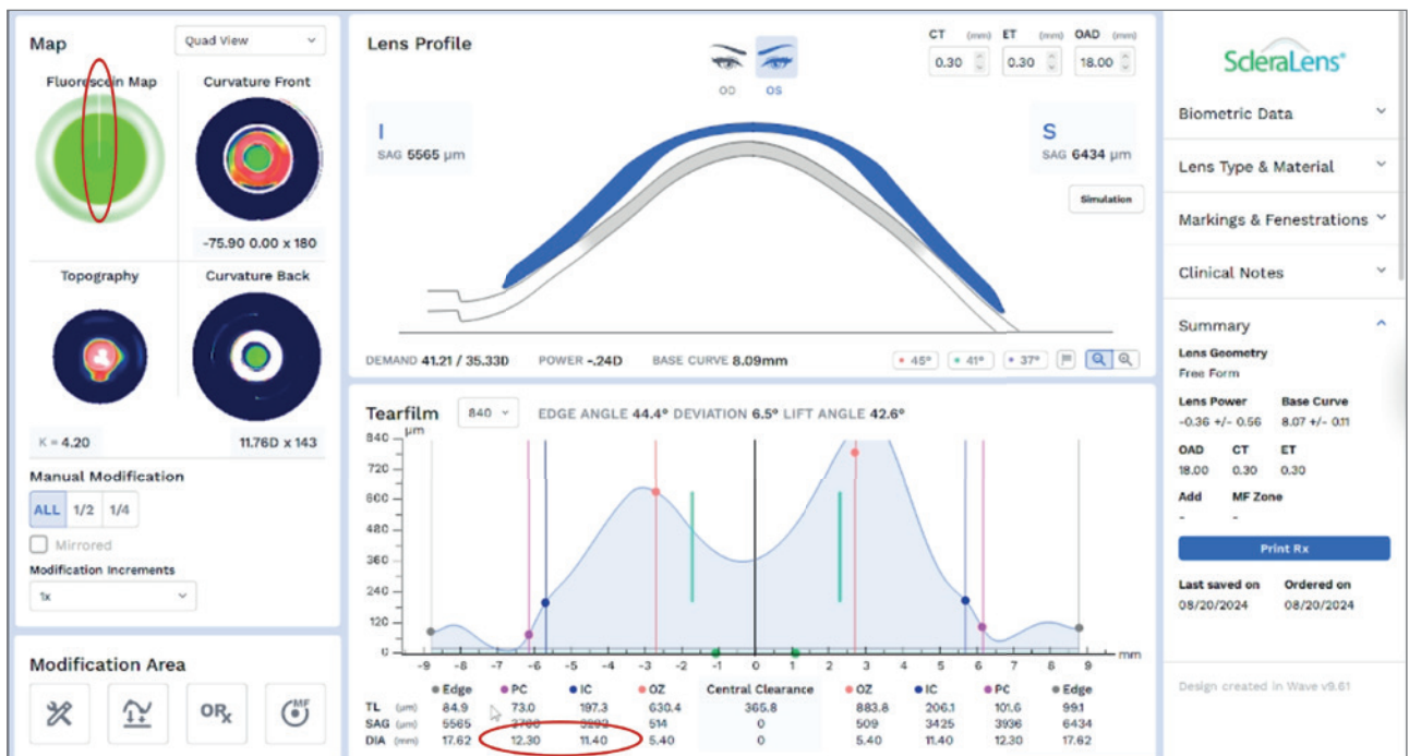
Abb. 9: Linsendesign mit ovaler Wölbung, basierend auf einem kleineren IC von 11,40 mm, beträgt der vertikale Wölbungsdurchmesser 12,30 mm.
